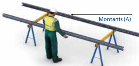
Pour une meilleure compréhension, le montage suivant sera décrit en position verticale, mais pour des échelles de hauteur importante, il est recommandé de les mettre en position horizontale tel qu'indiqué sur le croquis ci-dessus.
